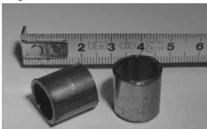
Abb.1: Tracer aus Eisenrohr mit 15 mm Länge und 15 mm Durchmesser
